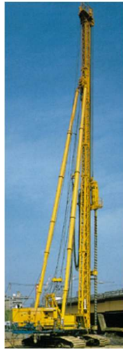
図1 機械攪拌工法の施工機と攪拌翼：CDM 工法の例
