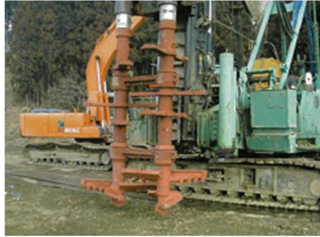
図1 機械攪拌工法の施工機と攪拌翼：CDM 工法の例
